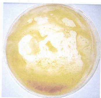
圖 3 第二組培養碟在黑暗處 24 小時後，發現細菌會生長在光觸媒塗層上
