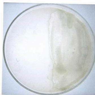
圖 4 在螢光燈下照射下，發現細菌不能生長在光觸媒塗層上（右邊）
